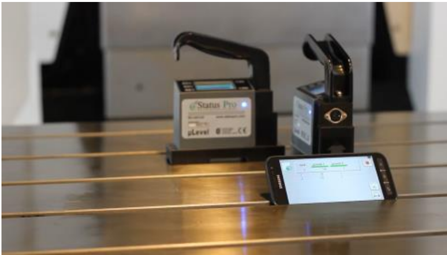
兩組 \mu Level 數位電子水平儀同步量測
