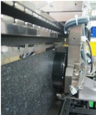
空氣軸承(浮動間隙: 5~15 \mu m, 負載: 150kg)
